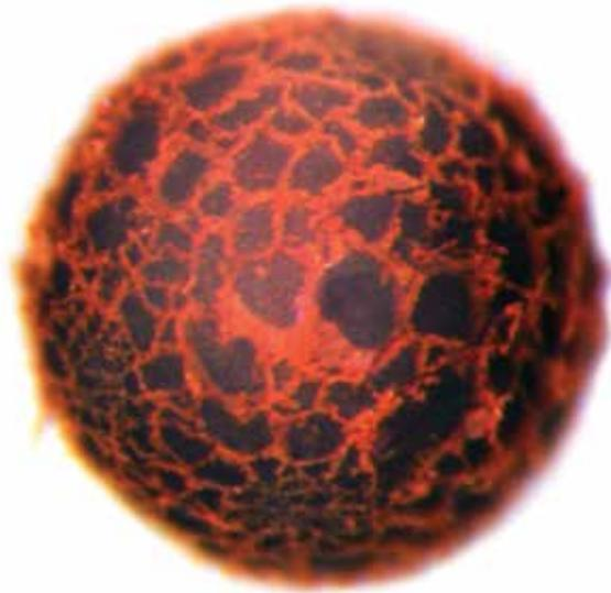
Kalzium- und Magnesium-Ionen werden aus dem Kationenaustauscher durch Natrium-Ionen ersetzt.
